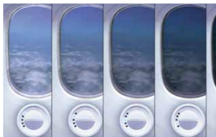
Cửa sổ thông minh được sử dụng trong máy bay thế hệ mới nhất Boeing 787 6
